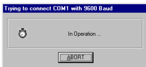
[ABORT] ボタンを押し、通信ポートを[Programmer] → [Setup host connection...]メニューから直接選択することもできます。
