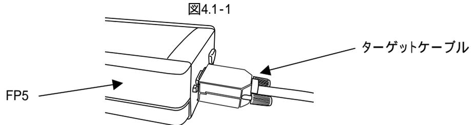
(2)ターゲット・ケーブルの16ピンと本FAアダプタのP1を接続します。
