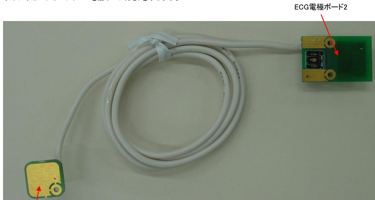
ECG電極ボード1は線材でセンサボードに接続されます。
