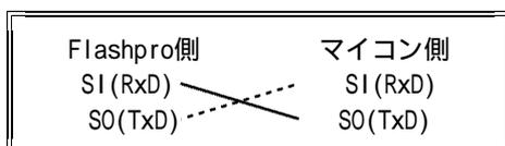
なお、IICによるインターフェースを行う場合は、FL-PR3側のSI端子がS D (シリアルデータ)のラインになりますので、SCK、及びSI端子の接続を行ってください。
