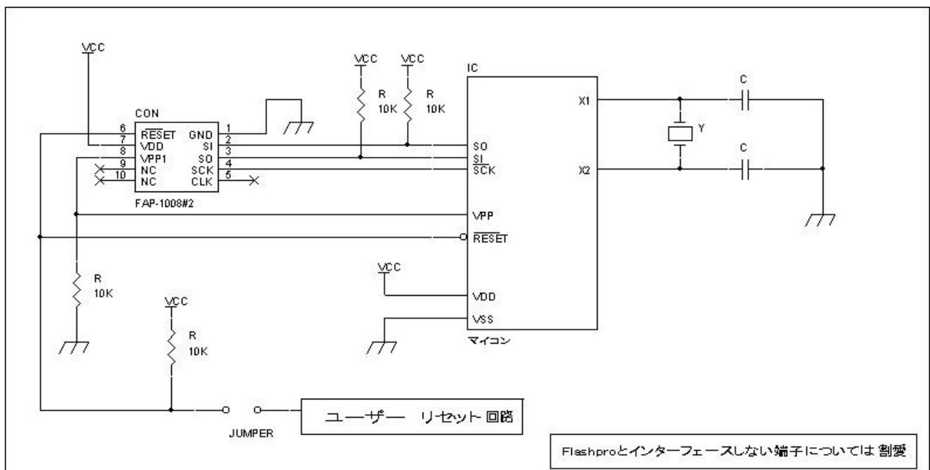
図4 SIOをインターフェースした回路例
