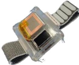
高性能を維持しながら部品点数を最小限に抑えたこのシステムには、眠気などの精神状態を推定し、SpO2、体温、心電図（EKG）に基づいて生理的異常を検出する高度なアルゴリズムを実行できる強力なMCU「RA6M1」を搭載。
